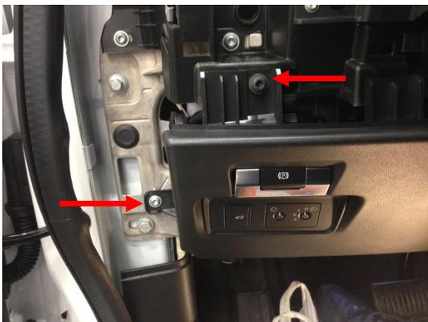
Выкрутить болты. Снять панель, отсоединить фишки.
