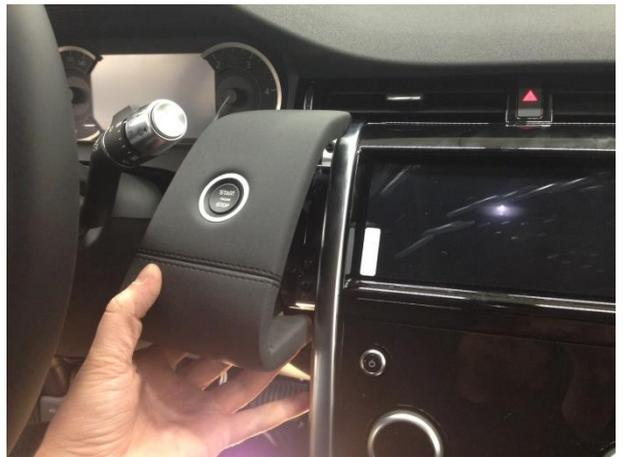
Снять панели, отсоединить фишки.
