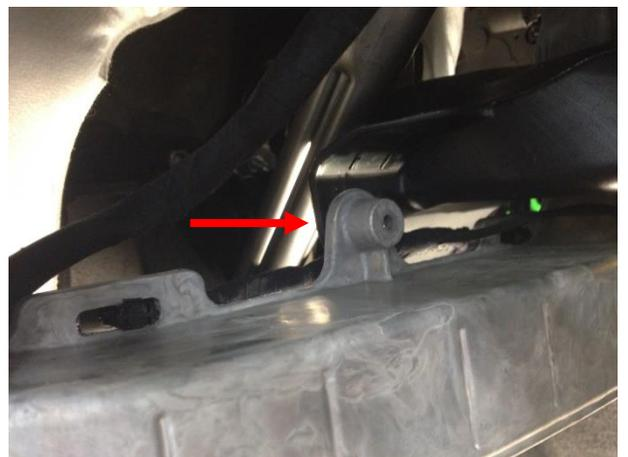
При необходимости выкрутить саморез и снять воздуховод.
